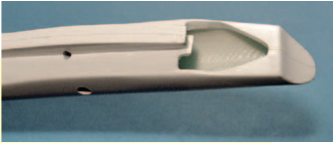
Ein herausragendes Detail ist die Befestigung des V-Leitwerks mit einer passgenauen Steckung mit Verschraubung durch die Rumpfsseiten. Die Leitwerksteile zentrieren sich durch die Verschraubung in den Rumpfaussparungen von selbst.
