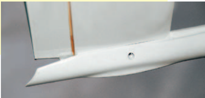
Ein herausragendes Detail ist die Befestigung des V-Leitwerks mit einer passgenauen Steckung mit Verschraubung durch die Rumpfsseiten. Die Leitwerksteile zentrieren sich durch die Verschraubung in den Rumpfaussparungen von selbst.
