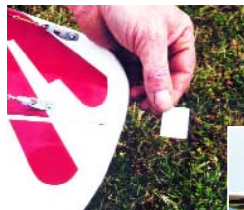
Das Scharniervlies ist eine interessante Art der Ruderbefestigung
