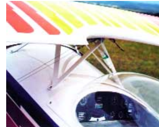
Der Anschluss der oberen Servos über einen zentralen Stecker
