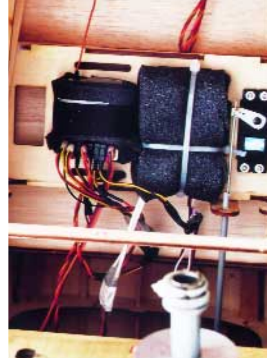
Genügend Platz für die Empfangsanlage
