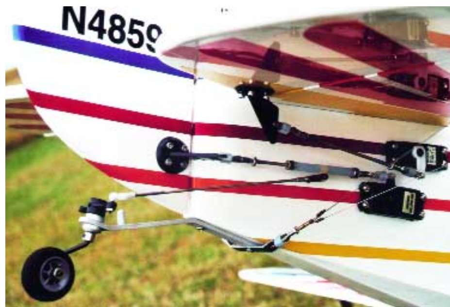
Die Anlenkung der Ruder mit dem Schutz für das Seitenruder
