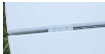
Die Vliesscharniere wurden im Testmodell durch Kavan-Scharniere ersetzt. Das gibt ein sicheres Gefühl, ist aber kein Muss
