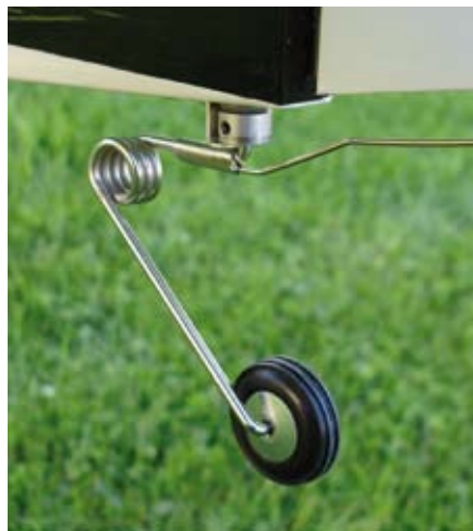
Das gefederte Spornrad wird über einen langen Torsionsstahl durch das Seitenruder mit angelenkt und überträgt so keine Schläge auf das Servo
