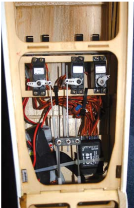
Es ist ausreichend Platz im Inneren des Modells, um die Servos im Rumpf nebeneinander zu platzieren
