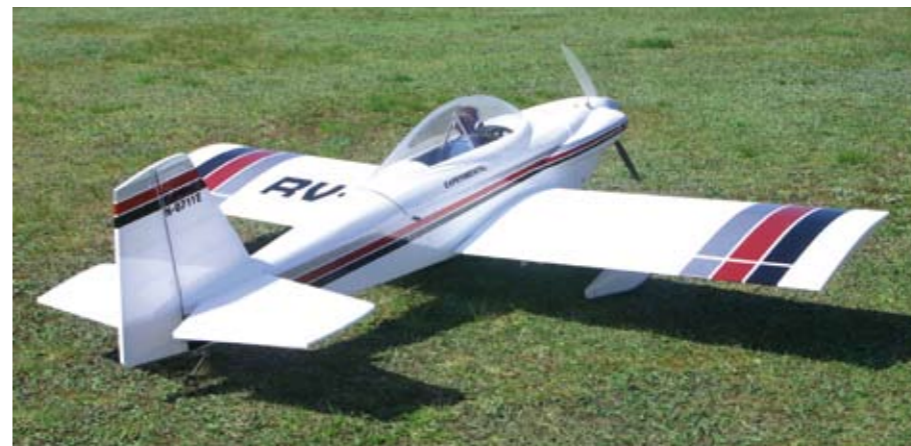
Ungewöhnlich für ein Kunstflugmodell, doch klassisch für einen Trainer, sind die Landeklappen. Sie steigern die Performance der RV-4
