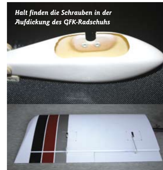
Ungewöhnlich für ein Kunstflugmodell, doch klassisch für einen Trainer, sind die Landeklappen. Sie steigern die Performance der RV-4
